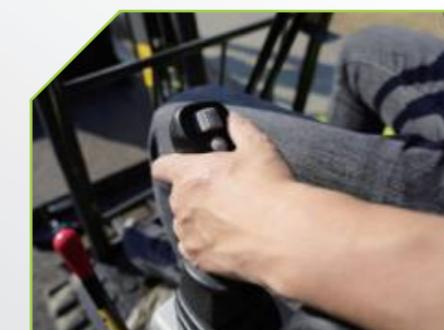
L'accoudoir réglable, parfaitement adapté au joystick, permet à l'opérateur de travailler dans la position la plus confortable avec une grande efficacité.
