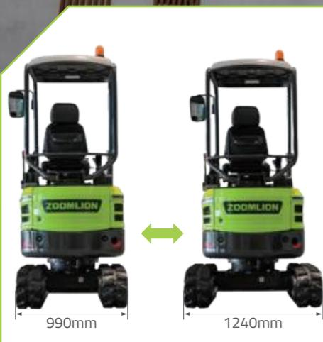
Rail rétractable, permettant de régler la largeur de la machine de 990 mm à 1240 mm. Dans un espace de travail étroit, la chenille se rétrécit, ce qui réduit la largeur de l'ensemble de la machine et améliore la praticabilité.
