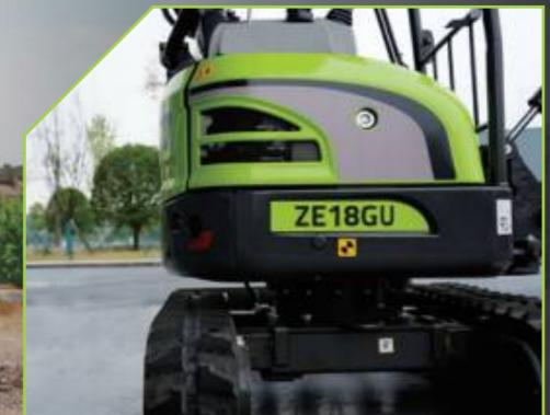
L'un des points forts de la ZE18GU est l'absence de pivotement de la queue, son rayon de pivotement ne dépassant pas la largeur de la voie à l'état complètement déployé. Cette conception lui permet de travailler dans des espaces étroits et sur des routes très fréquentées, sans être limité par l'espace.
